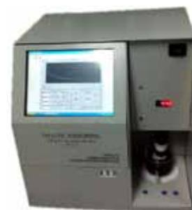
Figure 2: The VFA/TIC Automatic Titrator
