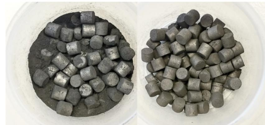
Abb. 2: Katalysator (EVT08) nach 15 min Trockenreformierung (links) und bei S/C=0,5 (rechts)
