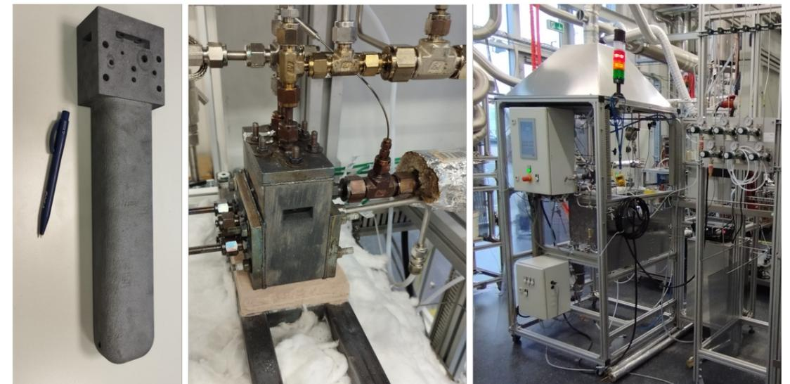
Abb. 5: Links: 3D-Druck des SiSiC-Einzelreaktors, Mitte: Gasanbindung des Reaktors mittels Flanschverbindungen, rechts: Versuchstand zur Untersuchung der Reformierung
