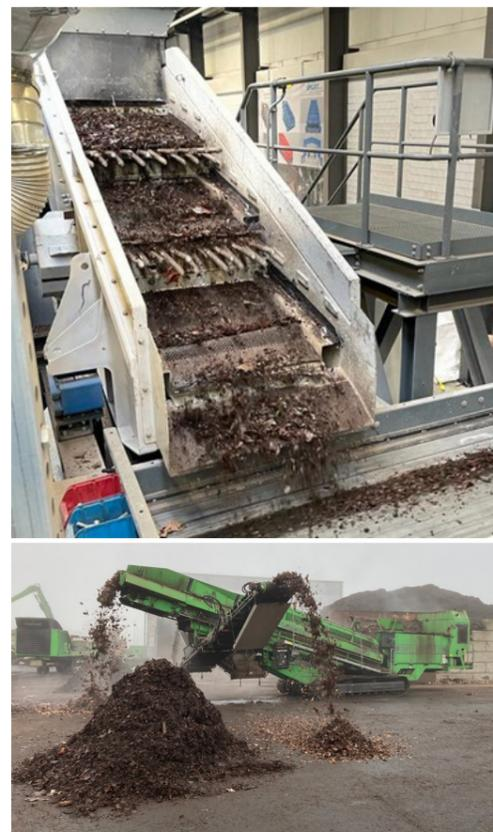
Abb. 3: Eingesetzte Siebtechniken: Sternsieb (links unten), Spannwellensieb (links), Trommelsieb (rechts)
