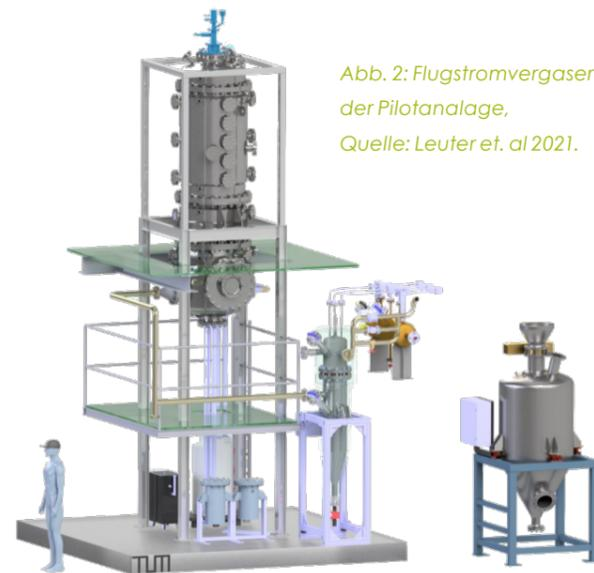
Abb. 2: Flugstromvergaser der Pilotanlage, Quelle: Leuter et. al 2021.
