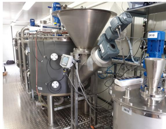
Abb. 4: Container-Biogasanlage für die halbtechnische Erprobung (Quelle: Vergara-Araya).
