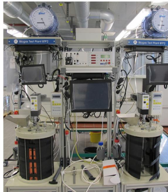
Abb. 2: Laborbiogasanlage für die kontinuierlichen Gärversuche (Quelle: Seick).
