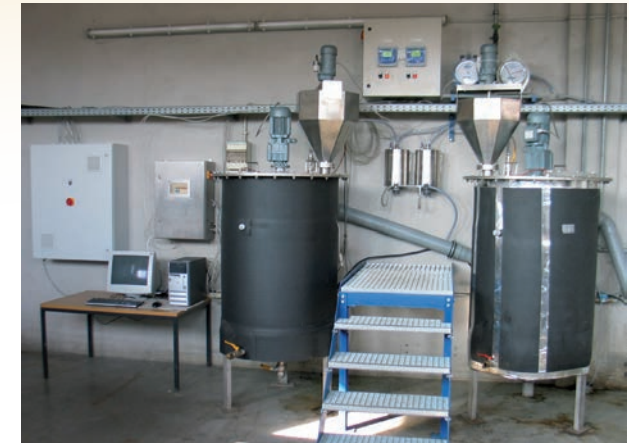
Biogasreaktor (Foto: Fraunhofer UMSICHT)
